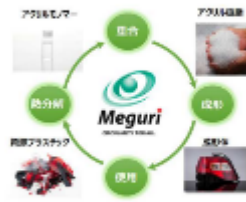
アクリル樹脂のケミカルリサイクルの仕組み
